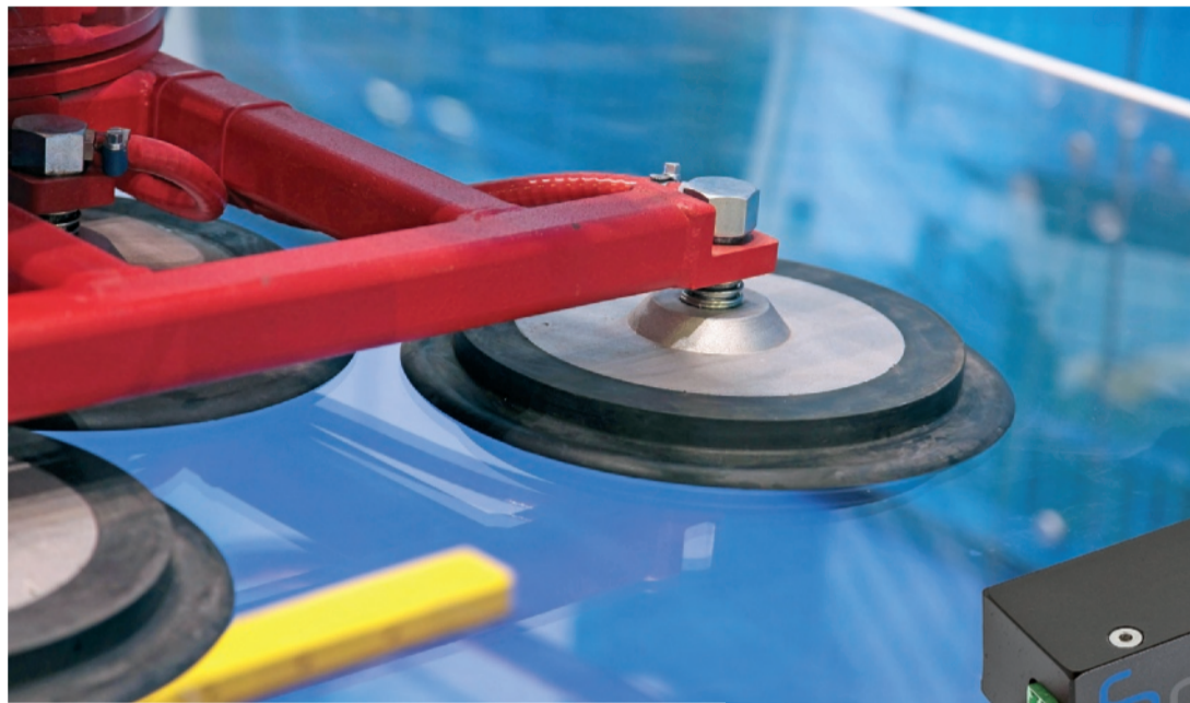
Siven è un sistema ottimizzato per il controllo della depressione negli azionamenti di ventose pneumatiche in grado di ridurre fino al 90% il consumo energetico.
