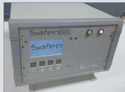
differenziale, ossia analizza il calo pressorio di un volume pressurizzato ed isolato attraverso il confronto con un prodotto-campione non affetto da perdite. Microleak trova applicazione nelle fasi di collaudo dei processi produttivi di diversi settori industriali quali l'automotive, il packaging, il food ed il biomedicale, differenziandosi dai dispositivi dei competitor per qualità delle performance di precisione della misura ed incremento della velocità del processo produttivo.
