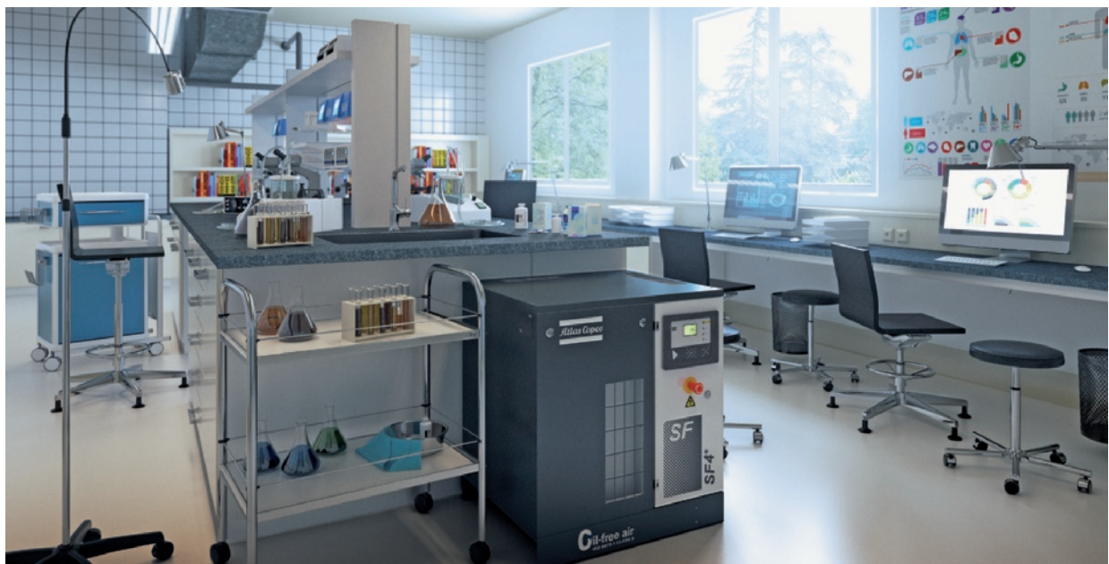
Fig. 3 – Compressore oil-free in laboratorio.
